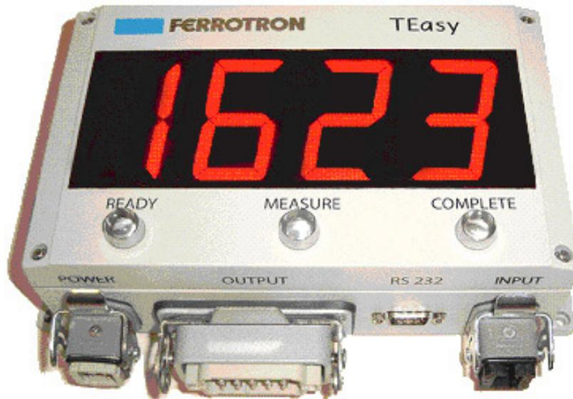
Das **TEasy** ist ein Temperaturmessgerät für flüssige Metallschmelzen und arbeitet mit Tauchtemperaturmesssonden unterschiedlicher Hersteller und Thermoelementen. Mittels schnell folgender Punktmessungen wird das einlaufende Temperatursignal erfasst, verfolgt, mit einstellbaren Parametern das Plateau bestimmt und auf dem Display angezeigt.
